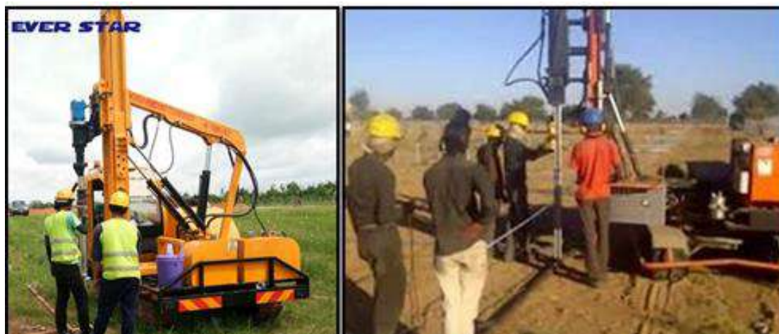
איור 84 - דוגמה למכונת נעיצה (Ramming machine)
